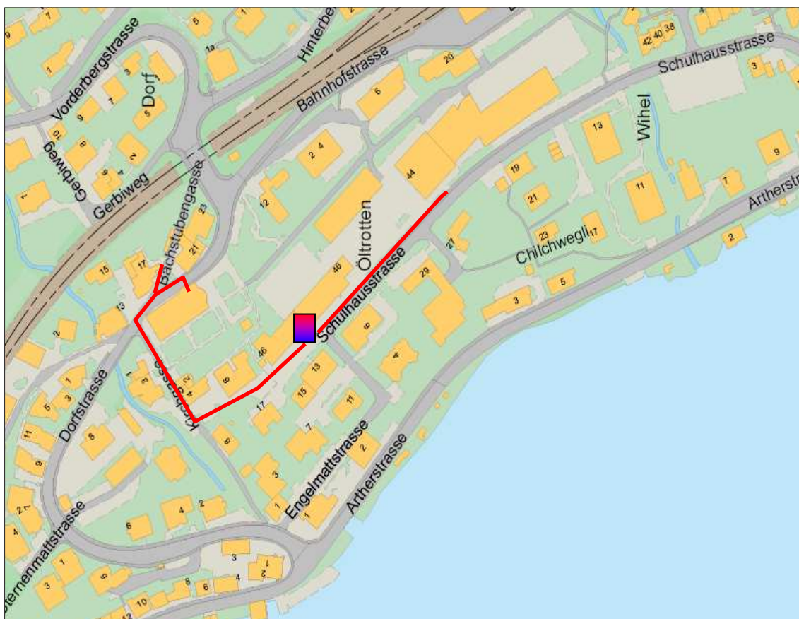
Abbildung: Roter Strich = Fernwärmenetz; Rotblaues Rechteck = Fernheizwerk
